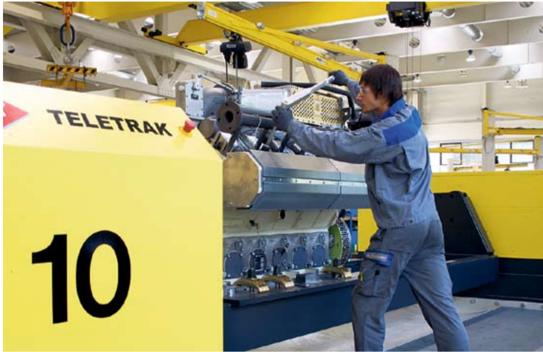
Ein Monteur bei der Prüfung eines Gasmotors in der Fertigungshalle der Motorenmontage von Jenbacher.
