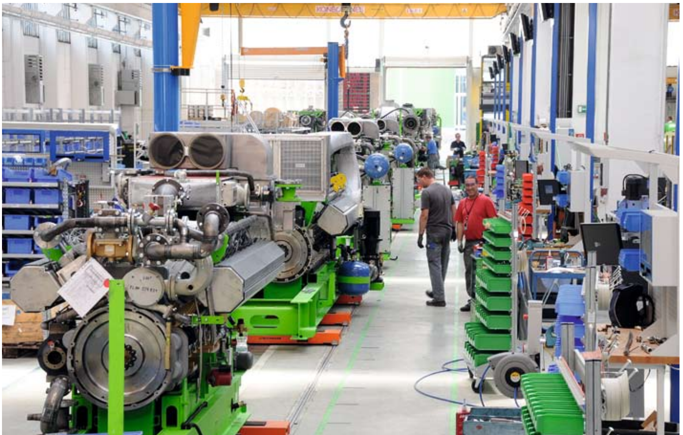
Ende September 2009 ist die neue «Flowline» in Betrieb genommen worden, wo Blockheizkraftwerke jetzt in einem 12er-Arbeitstakt produziert werden.
